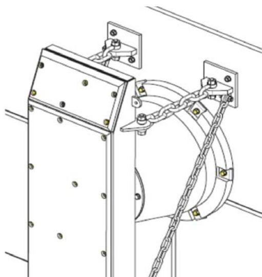
La forma conica del corpo rende il fender conico molto stabile anche con grandi angoli di compressione e offre un'eccellente resistenza alle forze di taglio.
